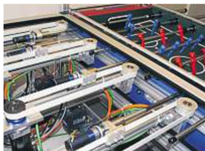
Der Computer entscheidet, Motoren bewegen die Kickerstangen. Foto: ka
